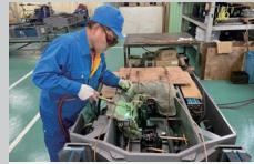
冷房装置オーバーホール
