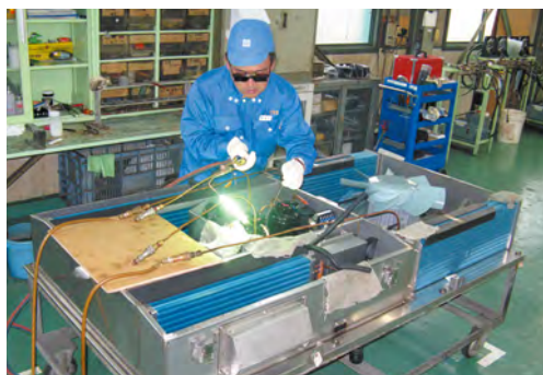
冷房装置オーバーホール
