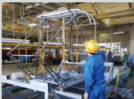
パンタグラフ点検
